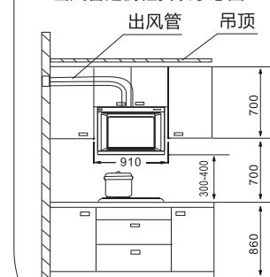
出风管走吊顶安装示意图
