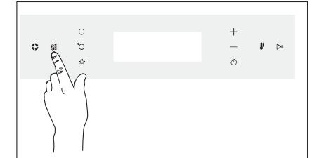
步骤三：按“”启动/停止键，机器即刻启动执行功能，开始加热工作；
